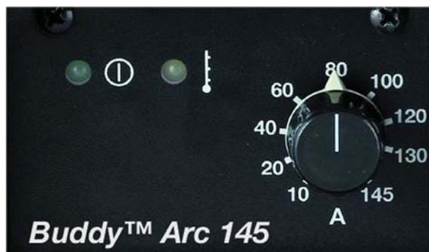
Buddy™ Arc 145 è molto semplice da usare. Basta una sola manopola per regolare la corrente di saldatura.
