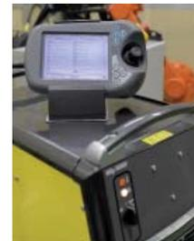
La tecnologia ESAB **TrueArcVoltage™** misura infatti la tensione di saldatura reale direttamente sull'arco e garantisce così la perfetta riproducibilità dei risultati. Guaine guidafile di varie lunghezze consentono un efficace avanzamento del filo dal fusto MarathonPac™ al dispositivo traina-filo, permettendo di ottimizzare il layout della stazione robotizzata.
