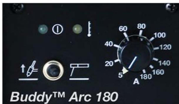
Buddy™ Arc 180 è dotata di una manopola per regolare la corrente di saldatura. Mediante un commutatore si può passare da modalità MMA al procedimento TIG.
