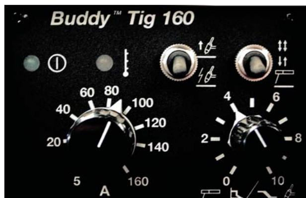
Il pannello di controllo della Buddy™ Tig 160 è dotato di una manopola per regolare la corrente di saldatura e di un'altra che regola il tempo di slope down in modalità TIG e l'intensità di ArcForce in MMA.
